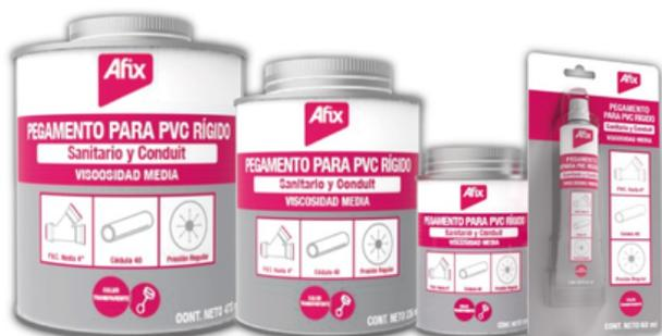
El producto AFIX® Pegamento PVC Sanitario Transparente ha sido diseñado para uso sanitario. Está recomendado para unir tuberías y conexiones de PVC rígido que estén sujetas a presión de cédula 40 hasta 4 pulgadas, y en el caso de tuberías que no lleven presión como los sistemas de tubería conduit, agua potable, drenaje, ventilación, etc. hasta 6 pulgadas.
